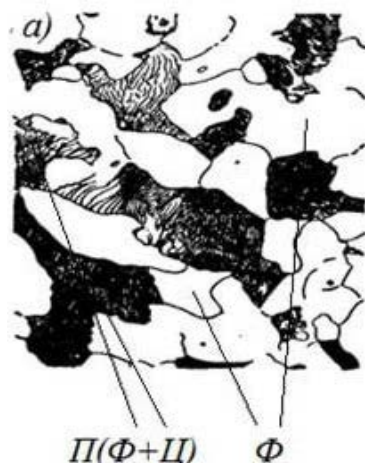
Рисунок 4.3 – Структура сталі після відпалу
