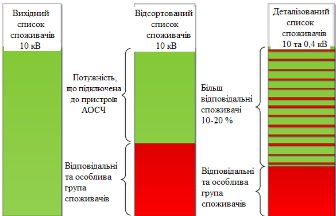
Рисунок 1.2 – Структура розподілу потужності навантаження, підключеного до системи АОСЧ
