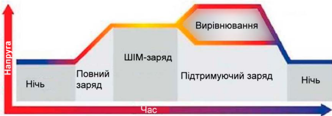
Рисунок 2.5 - Стадії заряду акумуляторної батареї від сонячної панелі
