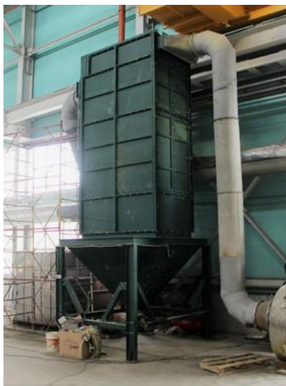
Рисунок 2.26 - Односекційний рукавний фільтр
