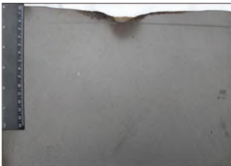
Рисунок 5.4 – Макроструктура з глибиною усадковою раковиною 20 мм головної частини зливка діаметром 300 мм сталі Х12МФ-Ш, виплавленого з введенням інокуляторів в процесі ЕШП (п'ятий варіант виплавки)
