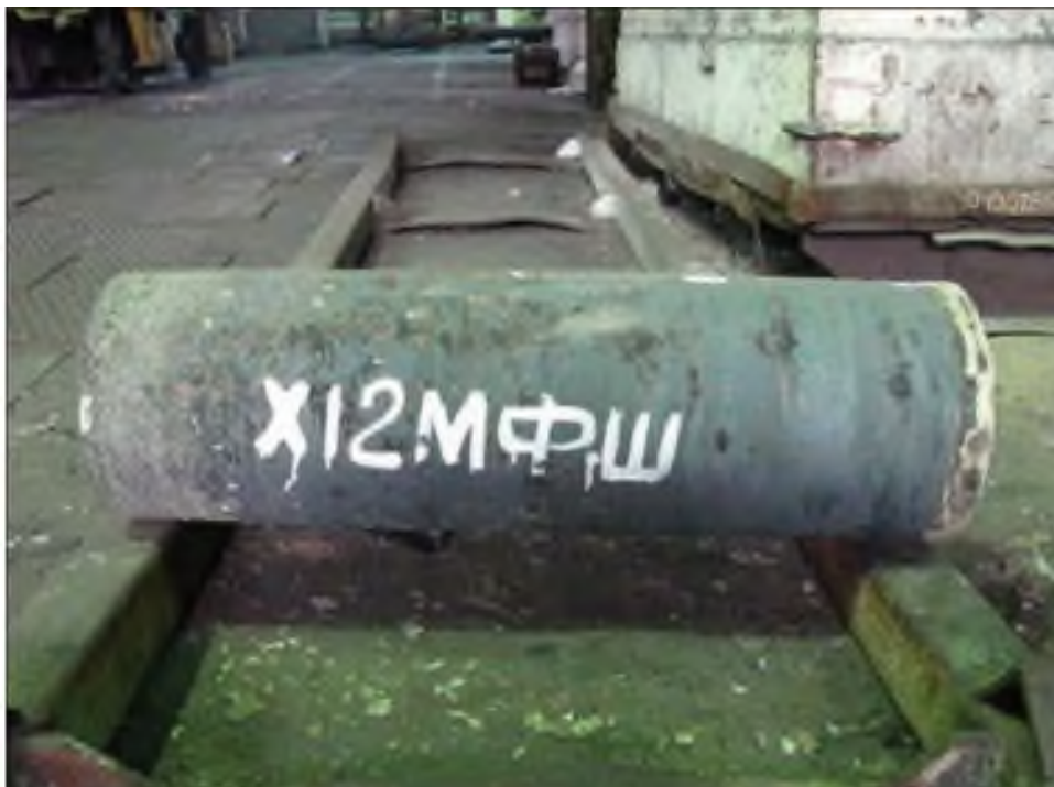
Рисунок 5.2 – Зливка ЕШП сталі X12MФ-Ш діаметром 300 мм, який виплавлений з введенням інокуляторів у процесі ЕШП
