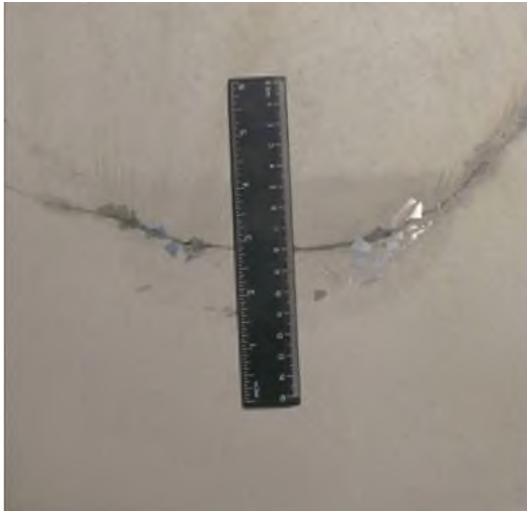
Рисунок 5.3 – Макроструктура та глибина металевої ванни зливка діаметром 300 мм сталі Х12МФ-Ш, виплавленого з введенням інокуляторів в процесі ЕШП (п'ятий варіант виплавки)
