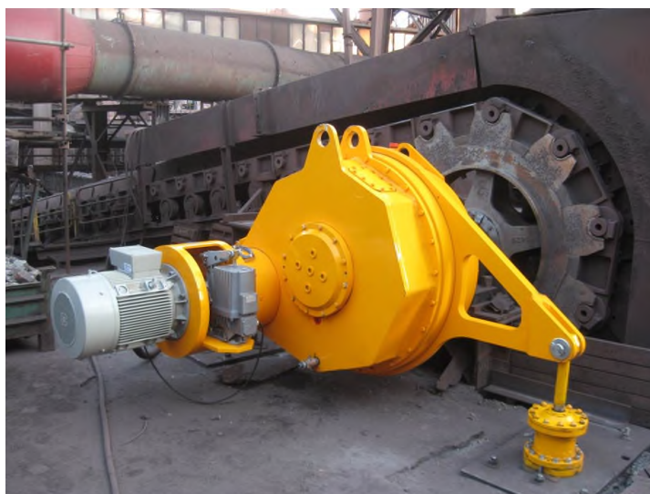
Рисунок 1.4 – Привід агломераційної машини
