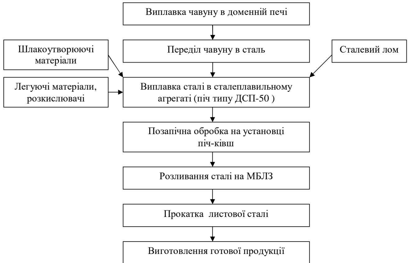
Рисунок 4.2 – Технологічна схема виробництва сталі 30ХГСА
