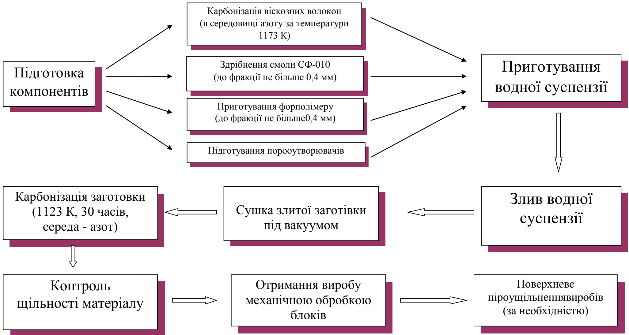
Рис. 3.1 Технологічна схема виробництва низкощільного вуглець - вуглецевого композиційного матеріалу методом зливу водної суспензії
