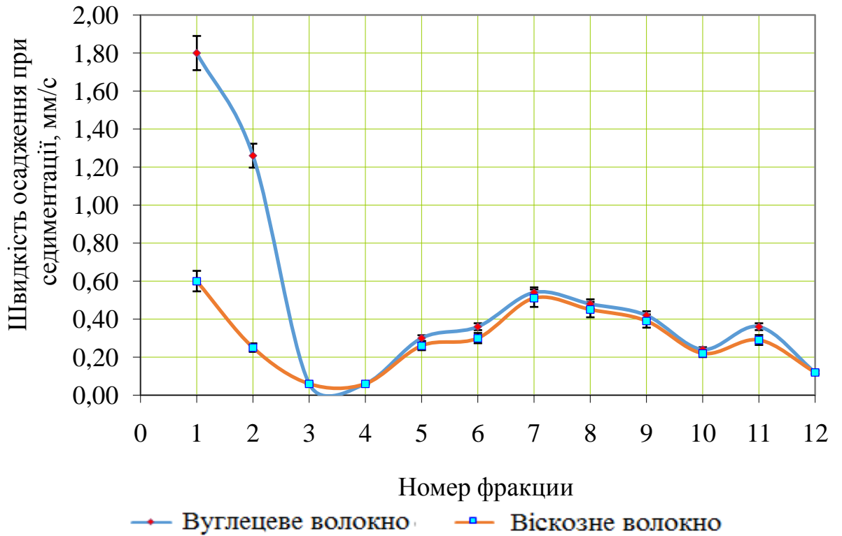
Рис. 3.14. Залежність швидкості осадження компонентів суспензії від їх фракцій у процесі седиментації
