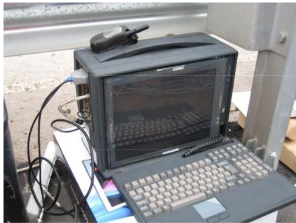
Рисунок 1.13 – Акустико-емісійний комплекс діагностування мостових конструкцій, бетонних та залізобетонних споруд [48]
