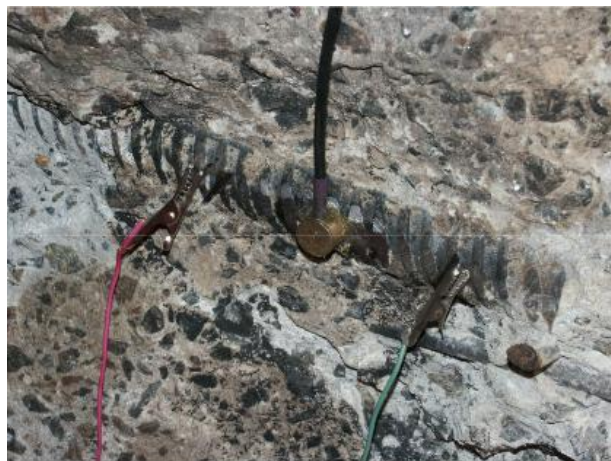
Рисунок 1.14 – Датчик для реєстрації сигналів АЕ та електроди для створення електричного потенціалу на арматурному стрижні [48]
