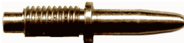
Рисунок 2.24 – Штатний електрод, робоча частина діаметром 4мм звужена до 3мм із півсферою
