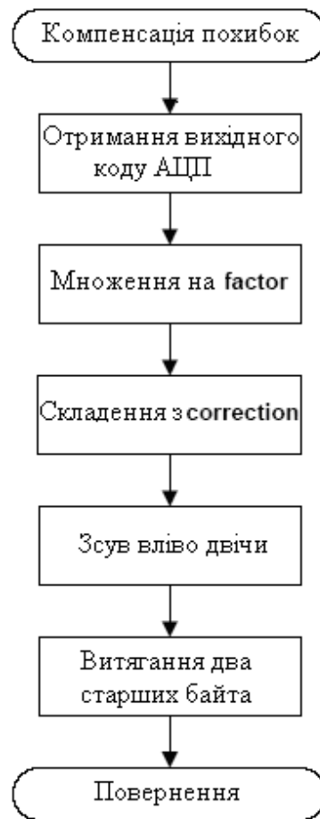
Рисунок 2.34 - Блок-схема програми компенсації погрішності зсуву і передаточної похибки
