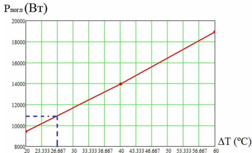
Рис. 4.53 Залежність потужності СБ, що віддається, від перегріву \Delta T Це означає, що реальна температура СБ при \xi = 2 - двостороння конвекція з урахуванням випромінювання дасть температуру T_{CB} = 47^{\circ}C .
