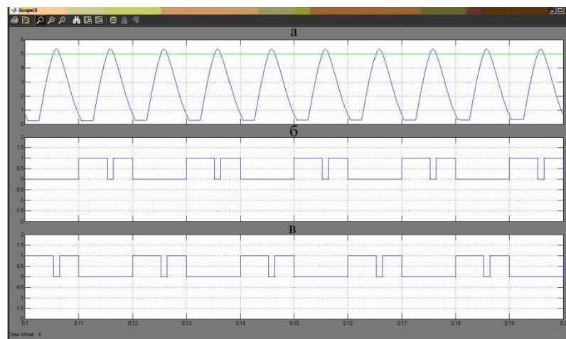
Рис. 4.36 а) Порівняння випрямленої напруги з опорним; б) Імпульси для транзисторів VT1 і VT4; в) Імпульси для транзисторів VT2 і VT3
