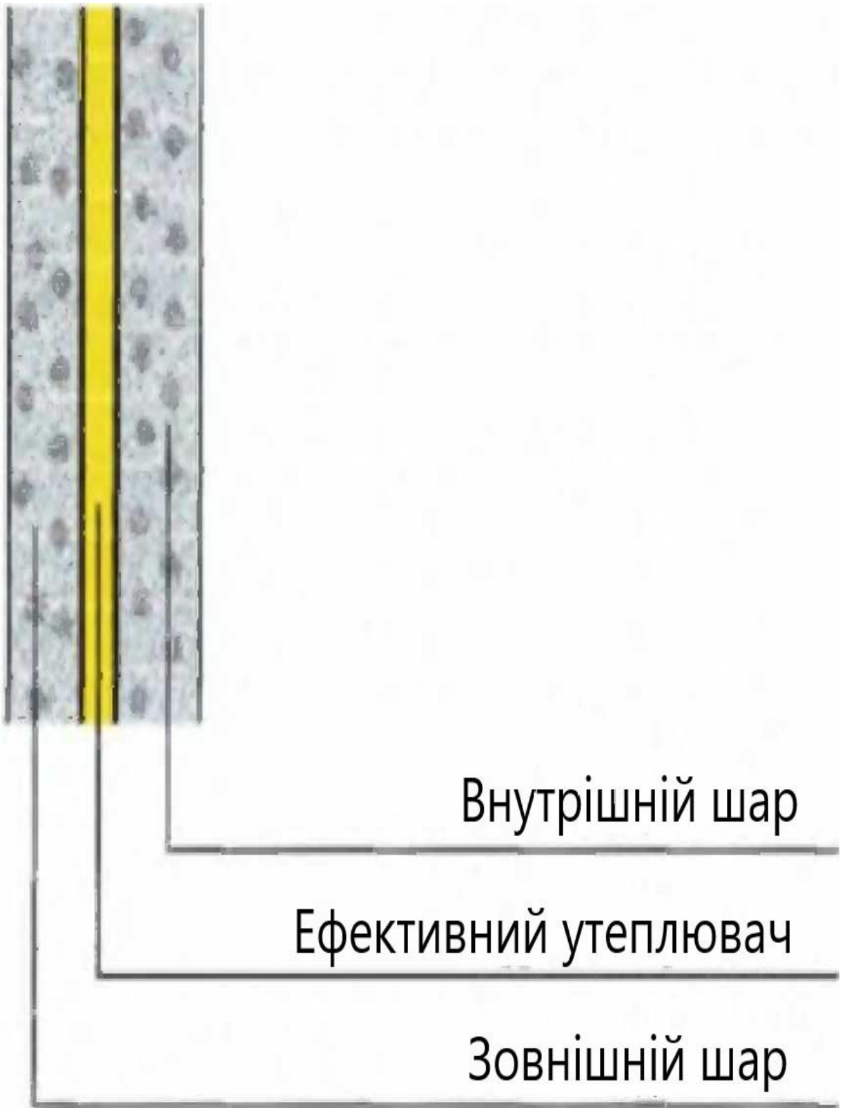
Рисунок 3.3 - Схема тришарової панелі з шарами з важкого залізобетону і ефективного утеплювача бетону
