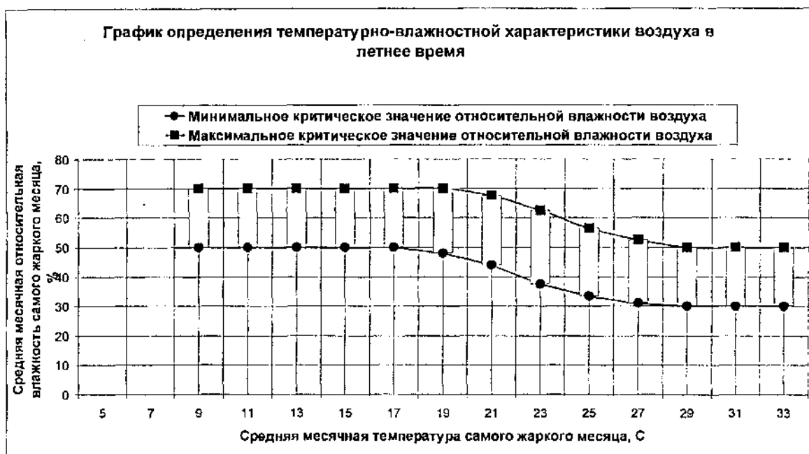
Рисунок 1.14 - Графік визначення температурно- характеристика вологості повітря в літній час
