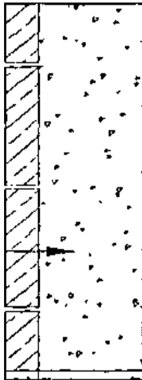
Рисунок 2.3 Стіна із залізобетону, фанерована природним каменем завтовшки 7 см
