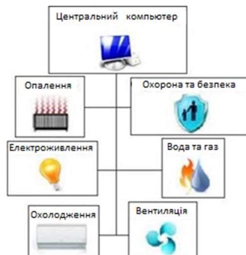
Рисунок 3.2 - Схема роботи BMS (Building Management System)
