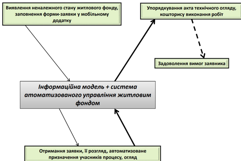
Рисунок 3.12 - Організація усунення несправності із застосуванням систем автоматизації
